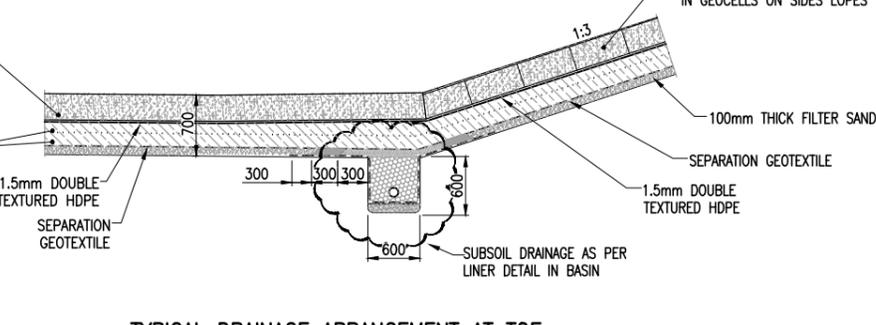
**TYPICAL DRAINAGE ARRANGEMENT AT TOE
