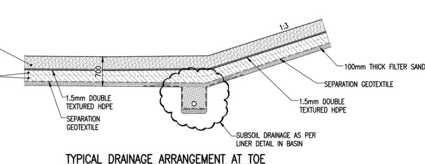
**TYPICAL DRAINAGE ARRANGEMENT AT TOE
